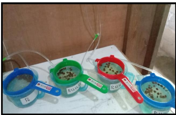
Gambar Uji stabilitas dalam air Sumber : Data Primer (2022)
